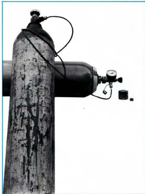
**Anmerkung:** Die Standardausführung PC 250/60 wird mit zwei Manometern geliefert:
